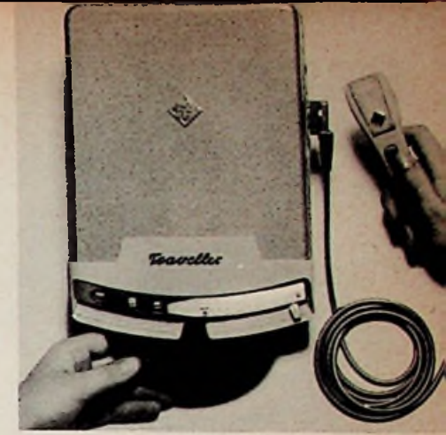
Bild 1. Batteriegespeistes Diktiergerät Telefunken-Traveller mit Kurzzeit-Tonträger
