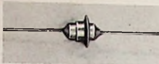
Bild 7. Durchführungskondensator mit Ferritmantel für Drosselwirkung (vgl. FUNKSCHAU 1957, Heft 15, Seite 416)
